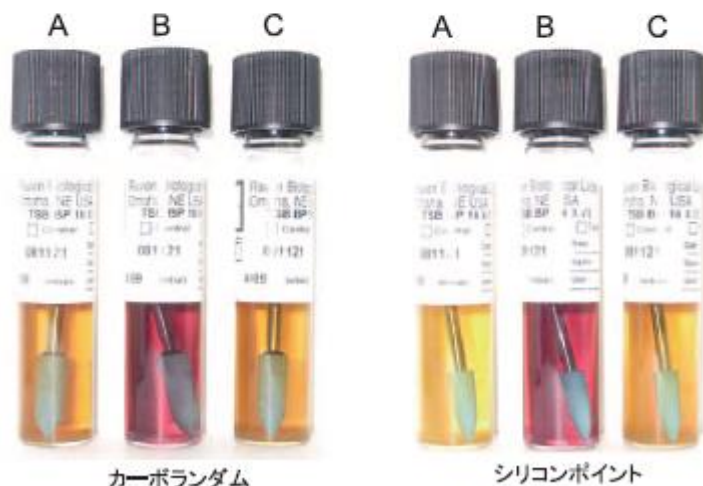
図 8 歯科用バーに対する滅菌効果（不成功例） A：未滅菌 B：オートクレーブ滅菌後 C：プラズマ滅菌後
